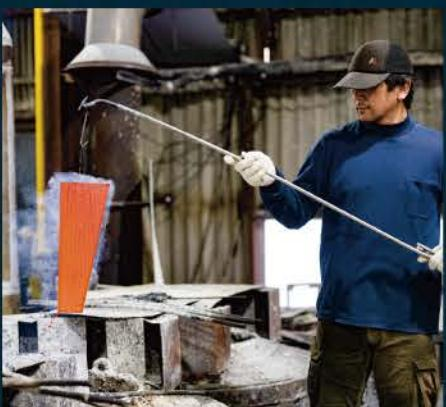
鋼材の機能を向上する塩浴熱処理の技術を応用した弊社独自の特許取得技術を用いて、ステンレスに酸化被膜を形成することで他の表面処理では得ることのできない美的価値の高い、複雑で独特な紋様が浮かび上がります。
