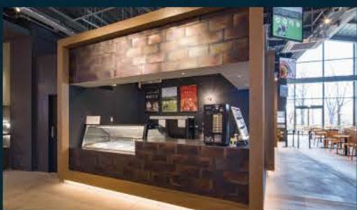
ヴィンテージ風加工着色処理をした金属板をカフェ内壁の装飾として活用。塩浴熱処理のソルトバスを利用し、独自の着色処理を施しました。
